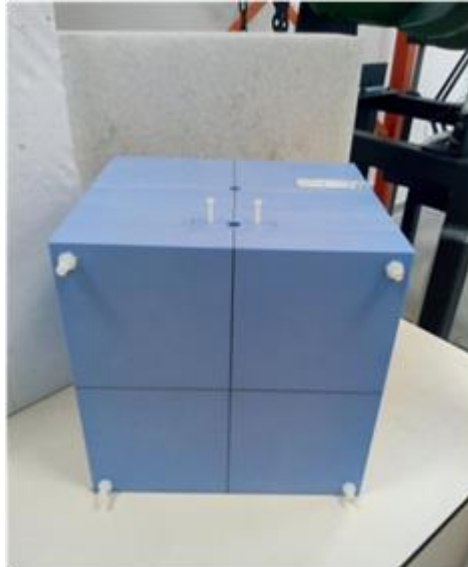
Снимка 6: Специален фантом към дозиметрична система RPLD
